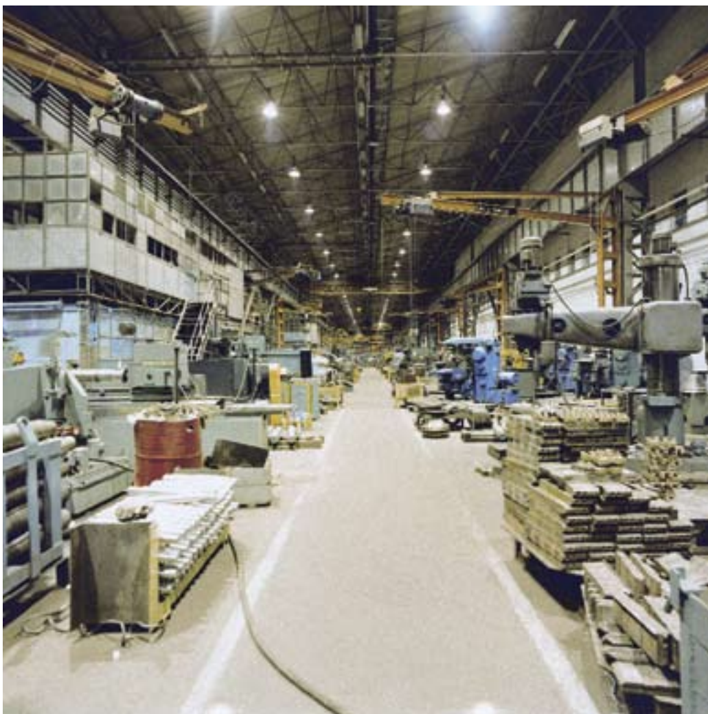
Высокие цеха металло-обрабатывающих заводов часто соответствуют классу IP 20. В этом случае, экономически оправдано применение обычных промышленных светильников с низким классом защиты.
