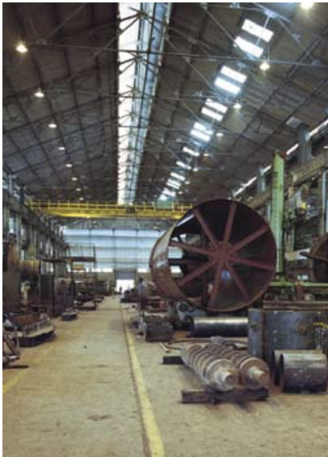
Освещение цеха выполнено промышленными светильниками с классом защиты IP 20.
