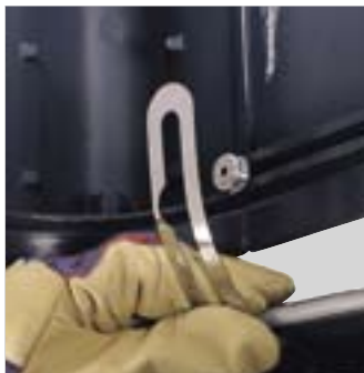
Замена стекла производится без применения инструментов
